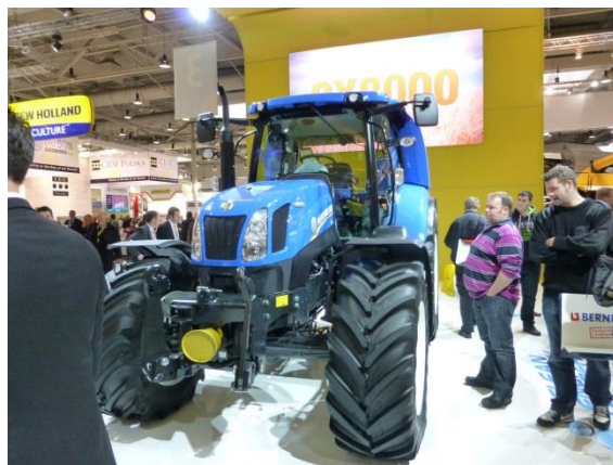
「メタン発電のトラクター」 (バイオガス発電で得たメタンで稼働)
