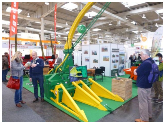
早生樹木刈取機(ヤナギなど刈取る) (木質バイオマス発電普及のため、有機物需要高まる)
